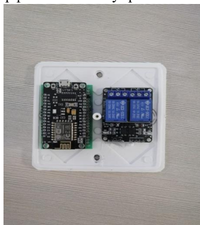
Рис.2. Контроллер, который управляет системой.
