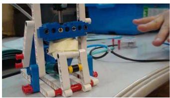
**Пресс** — механизм для производства давления с целью уплотнения вещества, выжимания жидкостей, изменения формы. На производстве прессы чаще всего используются, как устройство, позволяющее деформировать материалы с помощью механического воздействия для процесса штамповки. Штамповочные работы, штамповка, штампование — пластическая деформация материала с изменением формы и размеров тела. Чаще всего штамповке подвергаются металлы или пластмассы. По конструкции прессы бывают:
