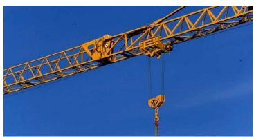
**Полиспаст** — натягиваемое верёвками или канатами грузоподъёмное устройство, состоящее из собранных в подвижную и неподвижную обоймы блоков, последовательно огибаемых канатом или цепью, и предназначенное для выигрыша в силе (силовой полиспаст) или в скорости (скоростной полиспаст)
