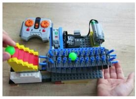
**Транспортер**, элеватор — транспортная машина непрерывного действия, перемещающая грузы в горизонтальном направлении или вверх под углом к горизонту по транспортерной ленте или в транспортных сосудах (ковшах, люльках), прикреплённых к тяговому органу.
