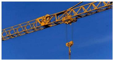
**Полиспаст** — натягиваемое верёвками или канатами грузоподъёмное устройство, состоящее из собранных в подвижную и неподвижную обоймы блоков, последовательно огибаемых канатом или цепью, и предназначенное для выигрыша в силе (силовой полиспаст) или в скорости (скоростной полиспаст)
