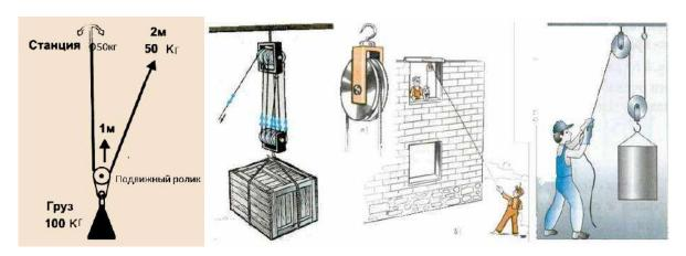
Если закрепить верёвку на станции (первая схема) и пропустить её через ролик на грузе, для поднятия груза необходимо усилие в 2 раза меньшее, чем его масса. Выигрыш в усилии — 2:1. В этой схеме ролик подвижный, потому что он движется вверх вместе с грузом. Чтобы поднять груз на 1 метр, кончику верёвки необходимо переместиться на 2 метра. Это — схема самого простого полиспаста 2:1. В этой схеме нагрузка на станцию — 50 кг.
